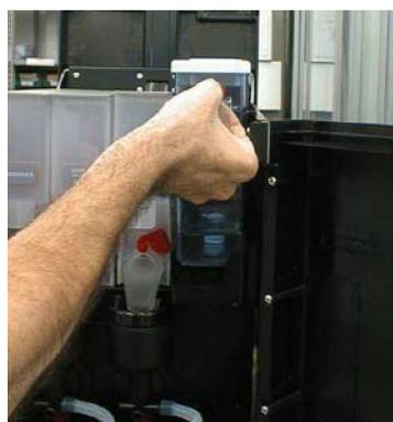
Zum Wasserfüllung, heben den Deckel auf oder nehmen den Wasserkanister aus und befallen den Kanister mit Trinkwasser.
