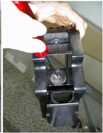
Zerlegen Sie beiden Seiten die Kreuzschlitzschrauben komplett.
