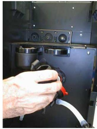
Die Silikonrohre für die Produktausgabe und die Halterungen der Produktausgabeschläuche abnehmen Die Mixerschale und die Rührscheibe abnehmen
