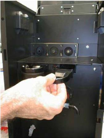
Alles in die vorher vorbereitete Lösung legen. Mit eine Tuch, das in die Lösung getaucht wurde, alle Teile der Mixer, die fest im Automaten bleiben, reinigen.
