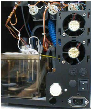
Auf der Rückseite des Automaten befindet sich ein Schalter, der alle elektrischen und elektronischen Teile mit Strom versorgt.
